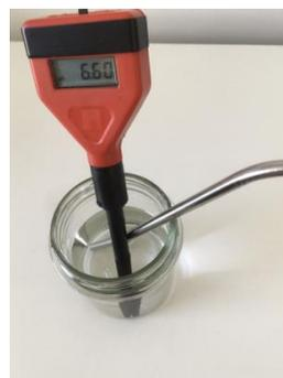
Medición del pH después del soplado.
