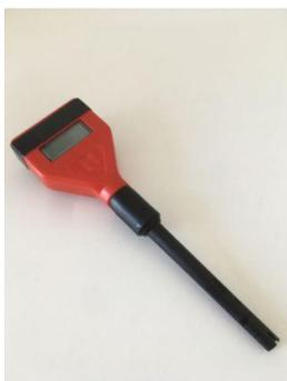
Medidor de pH con pantalla digital.
