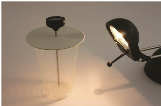
Medición de temperatura en el vaso cerrado y lleno con dióxido de carbono.
