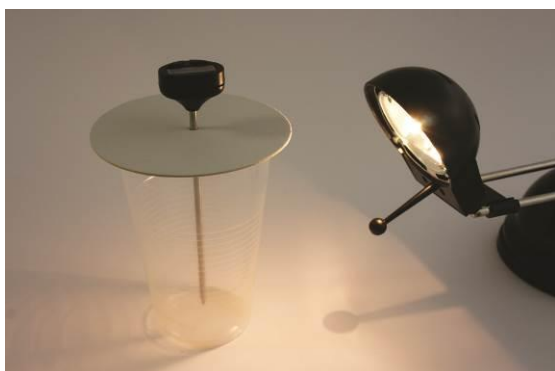
Medición de temperatura en el vaso cerrado.
