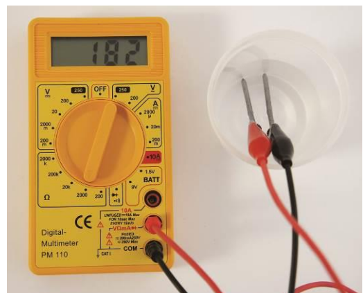
Fig. 3: Medición de la resistencia de la solución acuosa.
