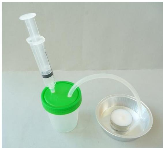
Montaje experimental del extintor de espuma.
