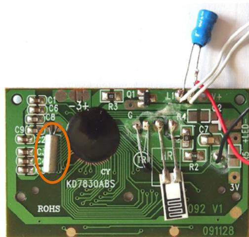
Figura 2: El interior ("tarjeta de circuito") de la estación meteorológica. Está destacado el componente ("condensador especial"), que es el responsable de medir la presión atmosférica.
