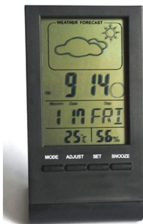
Figura 1: Estación meteorológica digital de mesa
