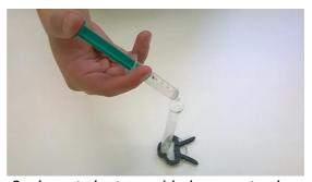
2. Inyecta lenta y cuidadosamente el agua de la jeringa en el tubo de ensayo.
