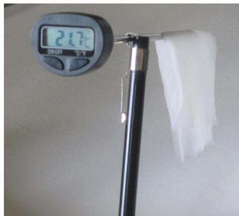
Medición de la temperatura ambiente con “refrigeración”
