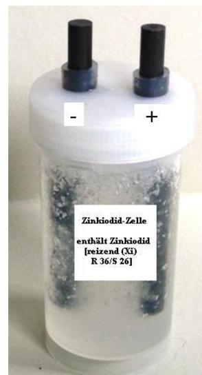
Fig. 2: Célula de yoduro de cinc terminada.
