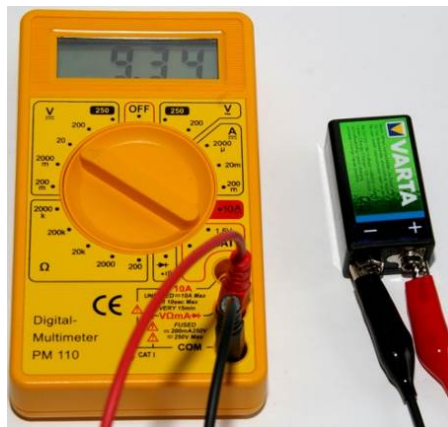
b) Se ha conectado correctamente el cable de medición al multímetro digital. En el display aparecerá una tensión positiva.
