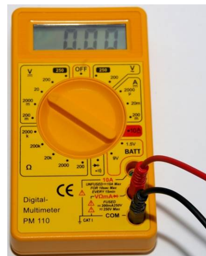
Fig. 4: Cómo conectar correctamente los cables de medición al multímetro.
