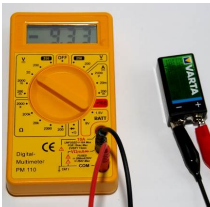
a) No se ha conectado correctamente el cable de medición al multímetro digital. En el display aparecerá una tensión negativa.
