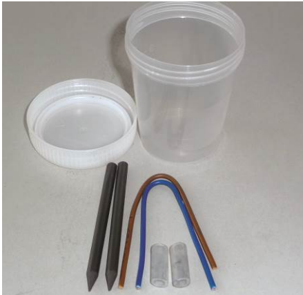
Fig. 13: Piezas para construir la célula electrolítica.
