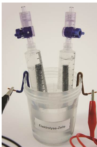
Fig. 18: La formación de gas tras conectar la pila.
