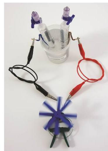
Fig. 19: La célula cargada con el gas de la electrólisis también puede generar corriente eléctrica.
