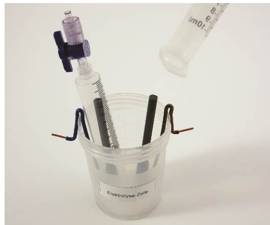
Fig. 16: Montaje final de la célula.
