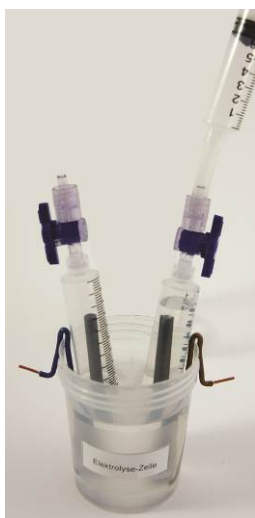
Fig. 17: Absorban el aire restante, los cilindros se llenan con la solución sódica.
