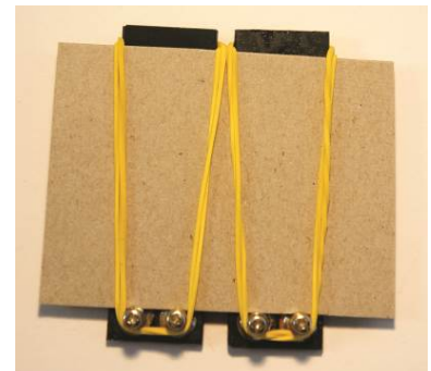
Fig. 4: Montaje de las células solares en una tira de cartón con una banda elástica.
