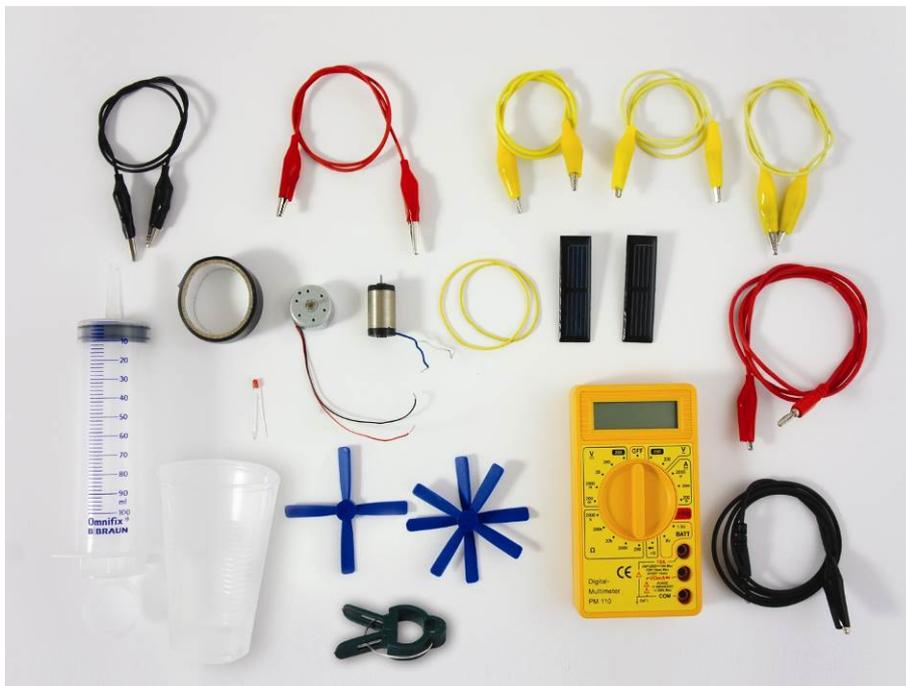
Fig. 2: Aparatos y materiales suministrados para los experimentos parciales 1 – 3.
