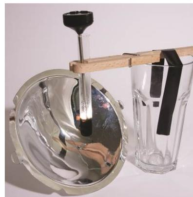
Fig. 4: La cinta adhesiva y un vaso grande y pesado para sustituir el trípode.
