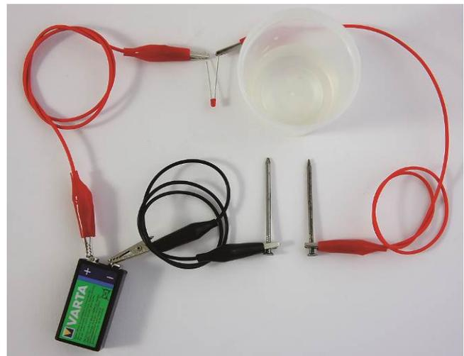
Fig. 4: Configuración de la medición para determinar la conductividad.
