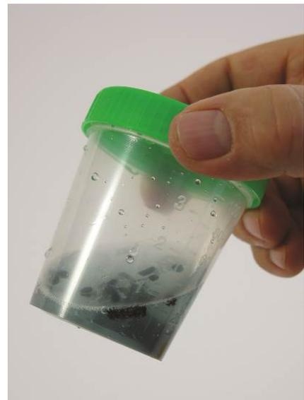
Fig. 3: “Sacudir” el colorante con el carbón activado.
