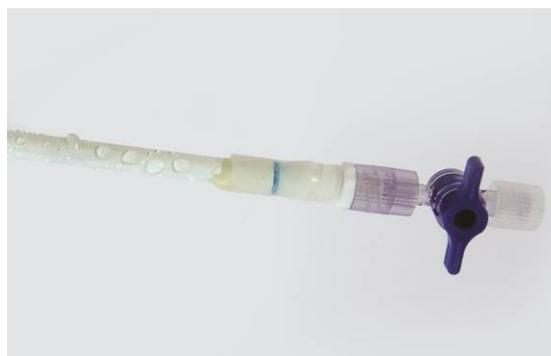
Fig. 9: El líquido filtrado que sale de la superficie del tubo de membrana.
