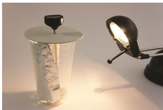
Fig. 4: Medición con un material de absorción de aluminio.
