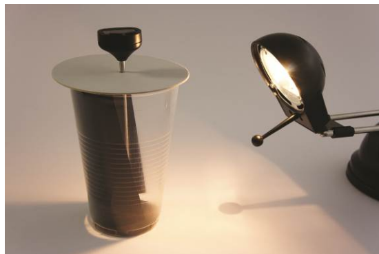
Fig. 3: Medición con un material de absorción negro.
