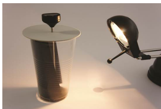
Fig. 1: Un modelo sencillo de invernadero: Un vaso de plástico transparente (de polipropileno), cerrado mediante una tapa, y papel negro para absorber.
