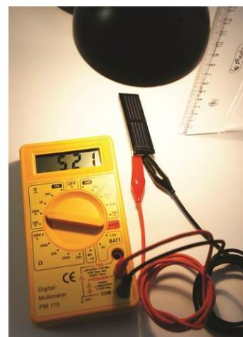
Fig. 5: La medición de la tensión a diferentes distancias.
