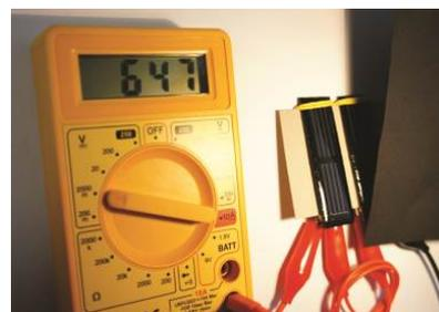
Fig. 13: Sombreado parcial de una de las dos células solares.
