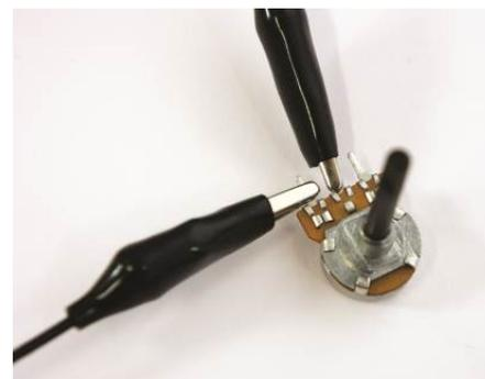
Fig. 17: Conexión en el potenciómetro sobre un contacto lateral y un contacto medio.
