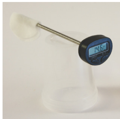
Fig 1: Es conveniente poner el termómetro durante la medición de tal manera que el disco de algodón cuelgue libremente en el aire, p. ej., sobre un vaso de plástico.
