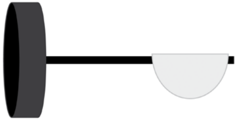
Fig. 2: La figura muestra cómo colocar el disco de algodón húmedo sobre el termómetro.
