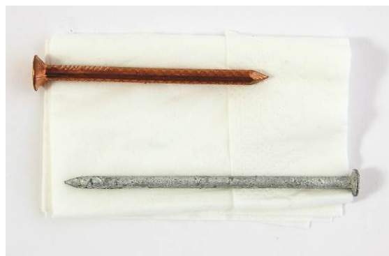
Fig. 9: Cómo envolver los electrodos en un pañuelo de papel.
