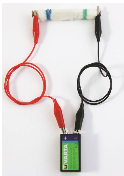
Fig. 2: Cómo cargar el paquete de electrodos.
