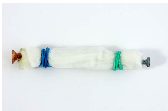
Fig. 10: El paquete de electrodos listo, mojado con la solución de salmuera.
