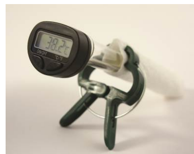
Fig. 3: Medición del enfriamiento del tubo de ensayo con un pañuelo de papel alrededor a modo de material aislador.
