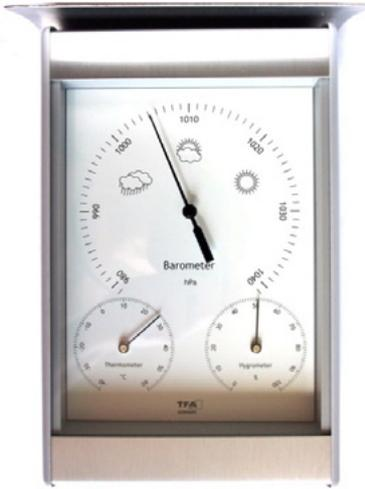
Figura 3: Barómetro analógico
